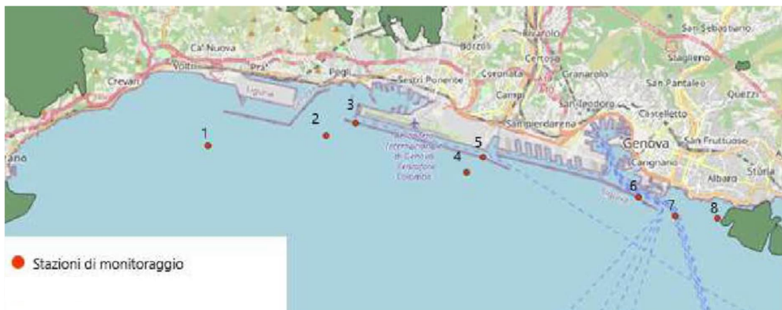
Figura 2.25: Posizione delle stazioni di monitoraggio per il campionamento degli inquinanti su colonna d'acqua e sedimento
